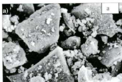
Figure 1a - 1b : Observation au MEB du laitier
